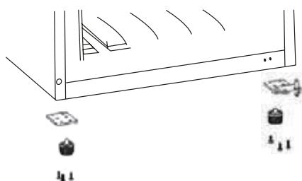
7. Skruva ur och ta bort det nedre gångjärnsstiftet, vänd på fästet och sätt tillbaka stiftet. Sätt tillbaka fästet och det nedre gångjärnsstiftet.
