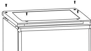
3. Brug en skruetrækker med lige kærv til at fjerne beskyttelsespladen på fronten.
