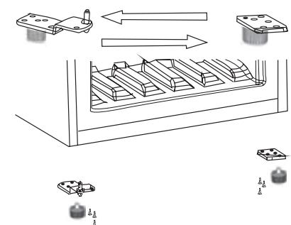
8. Montér hængselskruen foroven i det øverste hul i døren og skru fast med de fire skruer. Sæt derefter pladen på igen. Sæt skruepropperne på.
