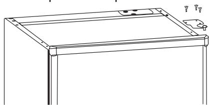
6. Ta bort de båda justerbara fötterna och skruva bort de två skruvarna till det nedre gångjärnsfästet.
