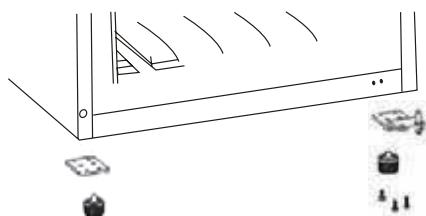
7. Skru ut den nedre hengselappen, snu braketten og skru tilbake tappen. Sett tilbake braketten med den nedre hengselappen.
