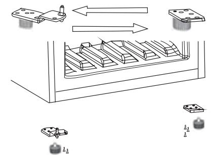
8. Asenna ylempi saranatappi yläoven reikään, ja kiinnitä se neljällä ruuvilla. Asenna sen jälkeen kansilevy paikalleen.
