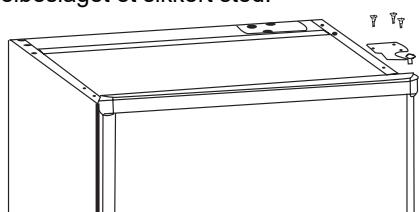
6. Fjern de to justerbare fodder, og skru skruerne ud af det nederste hængselbeslag.
