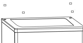
2. Skruva ur skruvorna och lyft av locket från baksidan (ställ undan locket). Lyft därefter upp den övre dörren och placera den på en mjuk yta (så att den inte repas).
