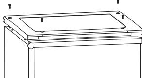
3. Avlägsna den övre skyddsplåten från framsidan (använd flat skruvmejsel).
