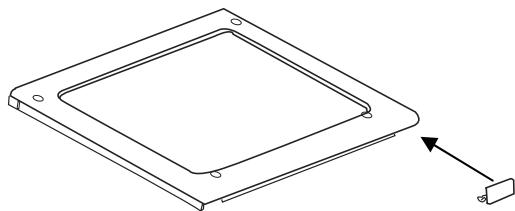
5. Ta av den øvre hengselappen, flytt den til venstre side og trekk den godt til. Legg hengselbraketten et trygt sted.
