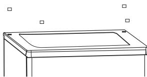
2. Irrota ruuvit ja nosta kansilevy takaosasta pois. Siirrä kansilevy syrjään. Nosta sen jälkeen ylempi ovi pois ja sijoita se pehmeää, naarmuttamatonta pintaa vasten.
