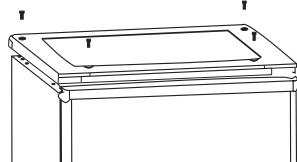
3. Bruk en flatbladet skrutrekker for å ta av toppdekselet fra fronten.
