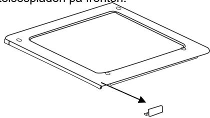
4. Montér den øverste beskyttelsesplade på den anden side.
