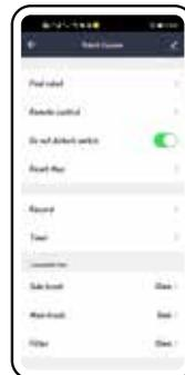
Nulstil kort: Klik på "Nulstil kort" for at rydde robotstøvsugerens aktuelle kort. Bemærk, at forbudte zoner og rengøringsområder nulstilles, når kortet nulstilles.
